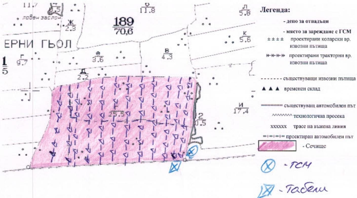
На схемата задължително се нанасят контурите на насаждението/имота, съществуващите и проектирани временни горски пътища, технологичните просеки, просеките за въжени линии, извозни пътища, временни складове както и връзката им със съществуващата автомобилна пътна мрежа.
