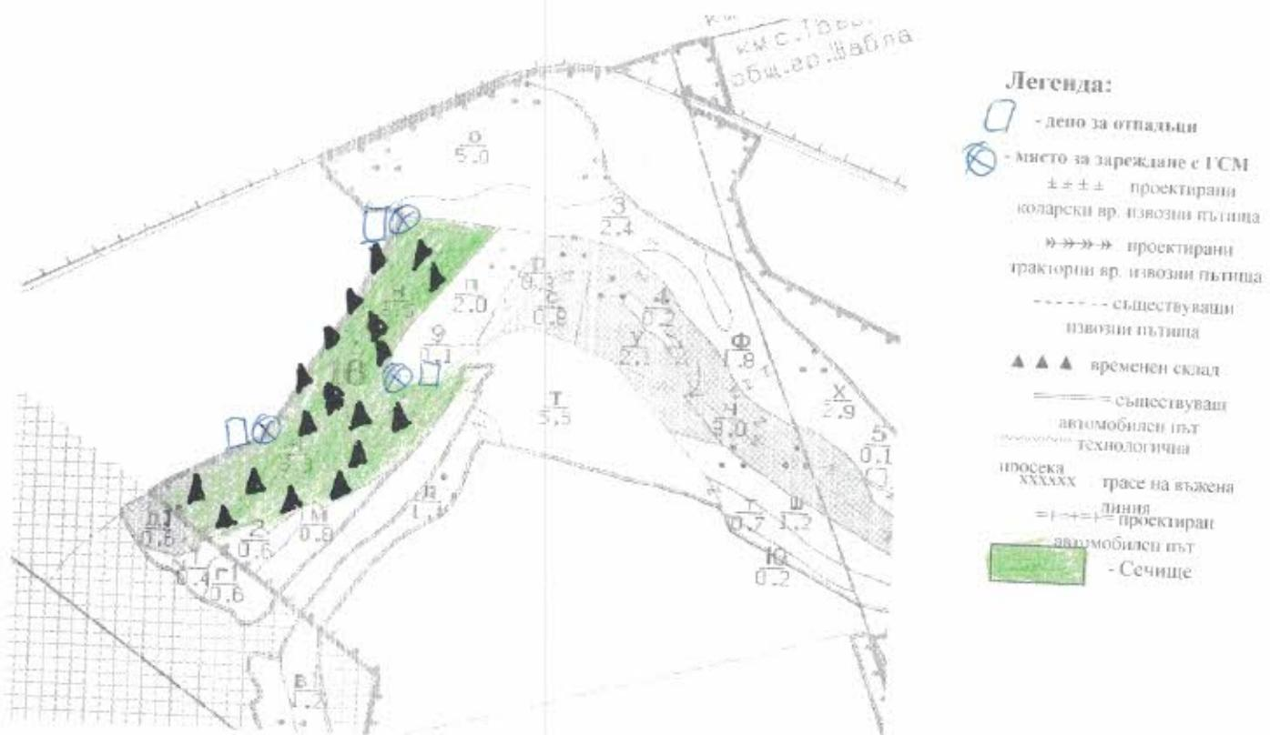
На схемата задължително се нанасят контуриите на насаждението/имота, съществуващите и проектирани временни горски пътища, технологичните просеки, просеките и възможните извозни пътища, временни складове както и връзката им със съществуващата автомобилна пътна мрежа.
